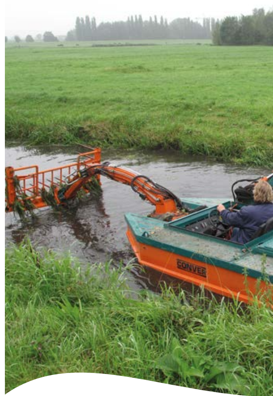
Een maaiboot met aan de voorkant een opduwframe en een zijmaaier aan de rechter zijde.
