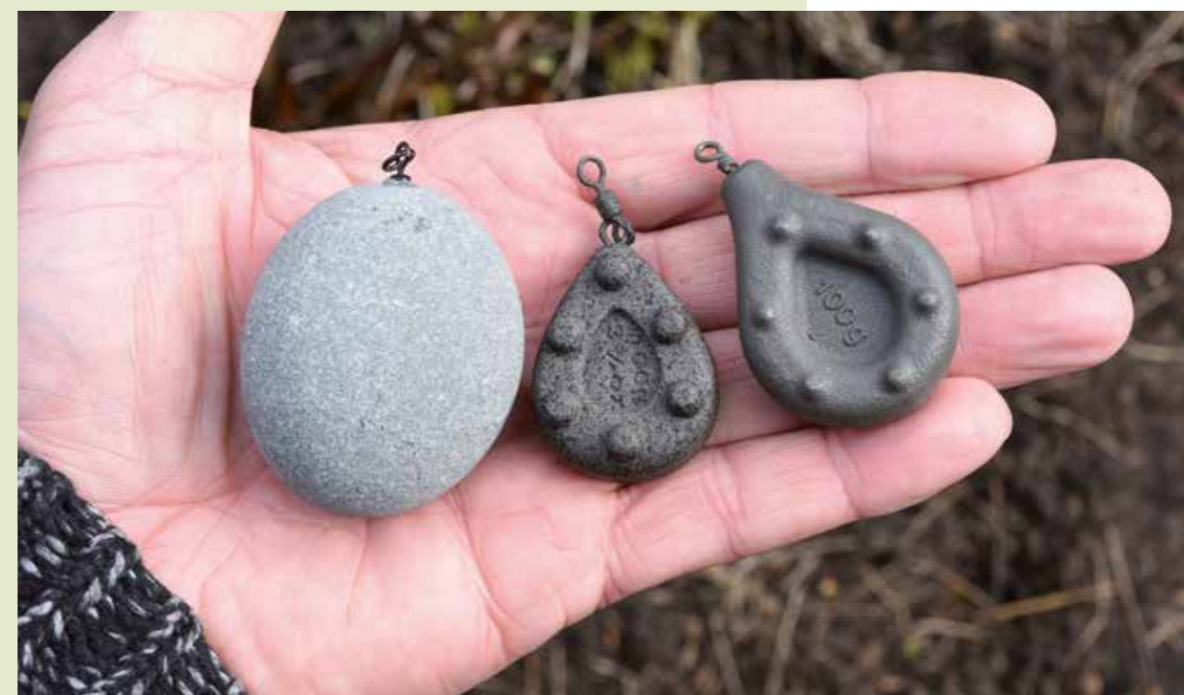
Verskil in grootte van werpgewichten van ongeveer gelijk gewicht: steen (105 gr), lood (106 gr) en staal (100 gr).
